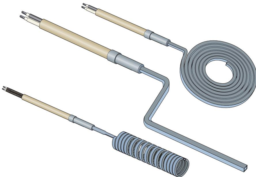
A lato alcune tipologie di pieghe tra le molteplici realizzabili con i riscaldatori microtubolari. E' possibile realizzare qualsiasi tipo di piega, fermo restando una particolare cura nell'attuazione della stessa, tenendo presente il raggio minimo di curvatura (mm.6) e il fatto che una volta eseguita la piega non è possibile riportare allo stato originale il riscaldatore, pena il danneggiamento irreparabile.
