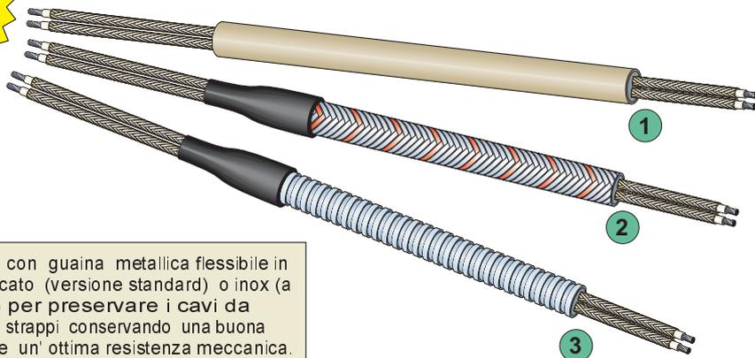
1) Protezione con guaina in fibra di vetro rivestita in silicone per alta temperatura e ad alto isolamento dielettrico. Elevata flessibilità e buona resistenza meccanica con massima temperatura di esercizio di 180° C (punte 230° C)
